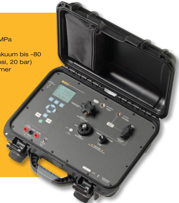
Der portable, pneumatische Druckkalibrator 3130 eignet sich ideal zum Kalibrieren von Drucktransmittern, Transducern, Manometern und ähnlichen Instrumenten. Das Gerät bietet alle erforderlichen Funktionen zum Geben, Regeln und Messen von Druck sowie zum Ablesen des vom Prüfling angezeigten Druckwerts.
